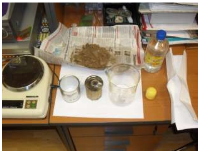
Рисунок 1 Отбор и подготовка к исследованиям проб торфа
