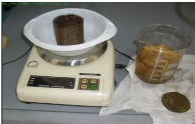
Рисунок 3 Измерения поглощения воды и водных растворов солей торфом
